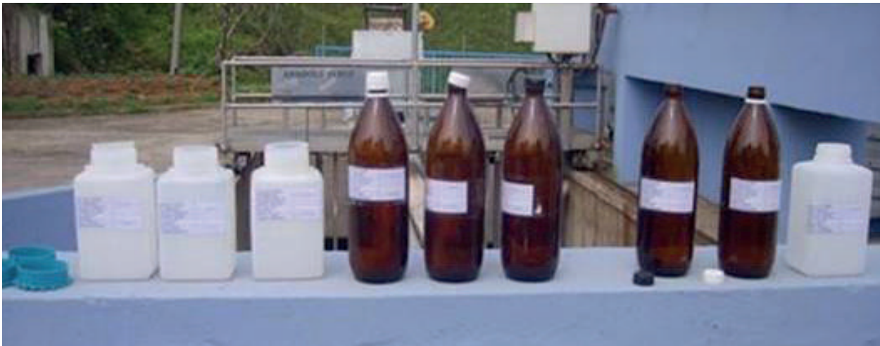
D.D.D. Tesislerinden numune alımı, numune türüne ve koruma önlemine göre ayrı ayrı örnekleme yapılmaktadır.
