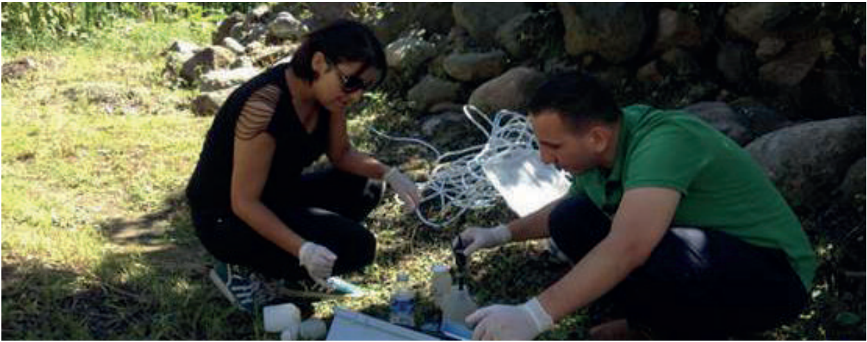
İlçe merkezinde kısmi kanalizasyon yapısının alıcı ortama atık su deşarj ettiği noktadan numune alımı ve yerinde yapılan ölçümler, numune türüne göre ayrı ayrı örnekleme yapılmaktadır.
